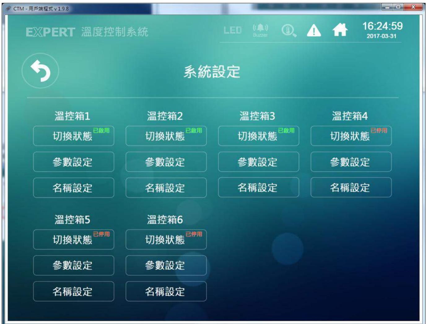
**切換狀態:** 直接點擊可以快速將溫控箱設定為啟用/停用狀態
